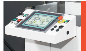
Écran tactile, traçabilité locale et interface avec réseau
